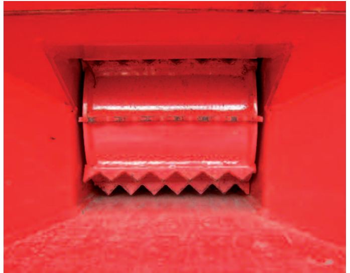
Die Einzugswalze im H 130 ist waagrecht angeordnet
