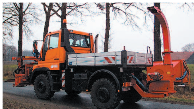
Holzhacker H 200, angetrieben durch die Hydraulik des Fahrzeuges, montiert auf einem Drehkranz
