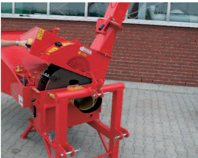
Die Tandemhackscheibe des H 130, H 160, H 200 und H 250 ist leicht zugänglich
