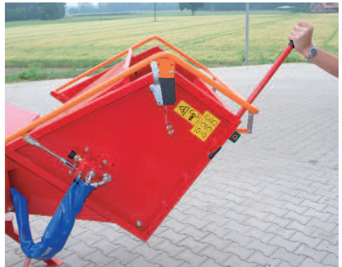
Holzhaacker der Baureihe H 200 / H 250, die praktische Einklapphilfe
