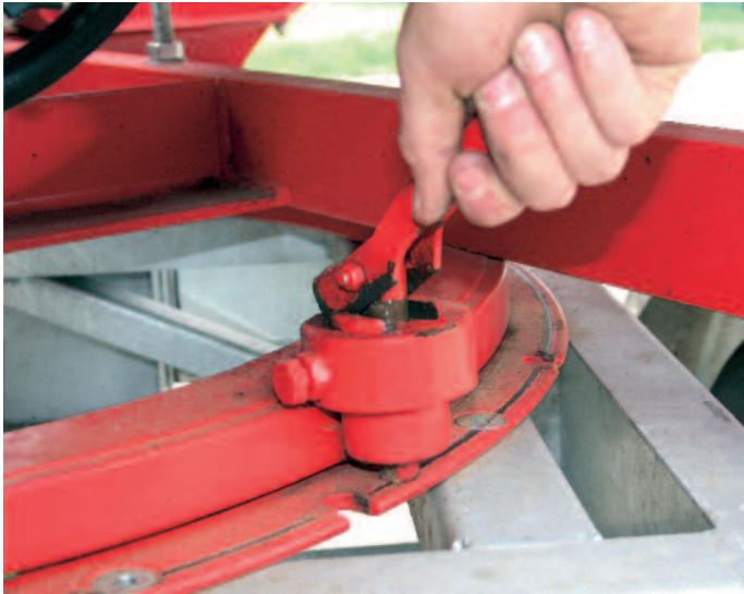
Einfache Arretierung des Hackers auf dem Drehkranz
