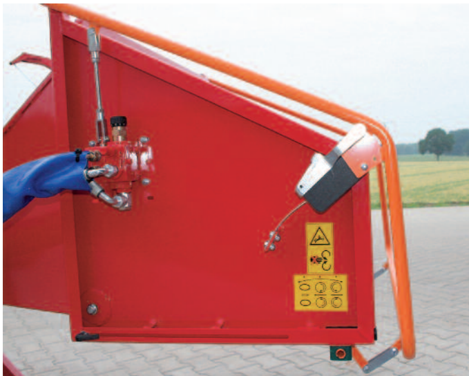
Schaltkulisse am Einzugsrichter am Holzhaacker der Baureihe 230
