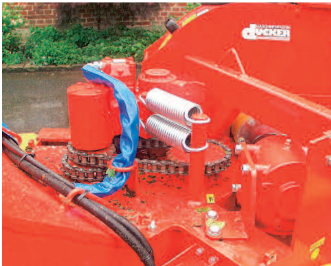
Holzhaacker Baureihe 230, hydraulischer Antrieb über Verbindungskette
