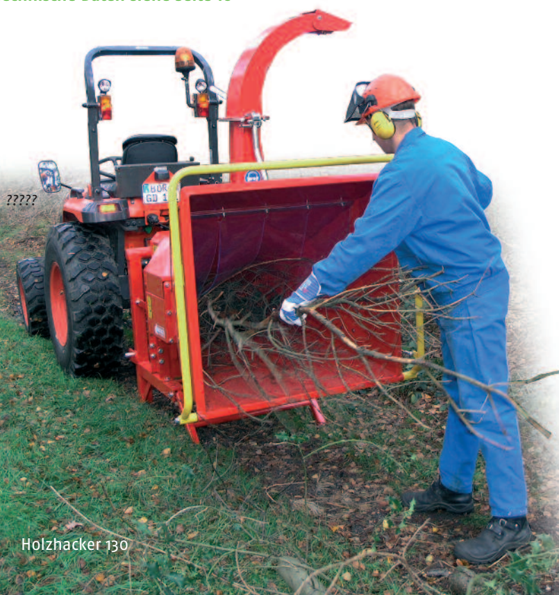
Großer Einführtrichter mit umlaufendem Sicherheitsbügel
