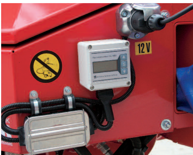
Drehzahlwächter mit Gesamt- und Tagesbetriebsstundenzähler am Holzhaacker der Baureihe 230
