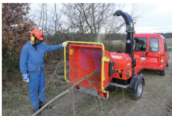
Einfache Bedienung über den umlaufenden Sicherheitsbügel
