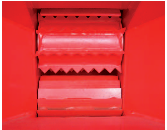
Waagrecht angeordnete Einzugswalzen im H 160, H 200 und H 250
