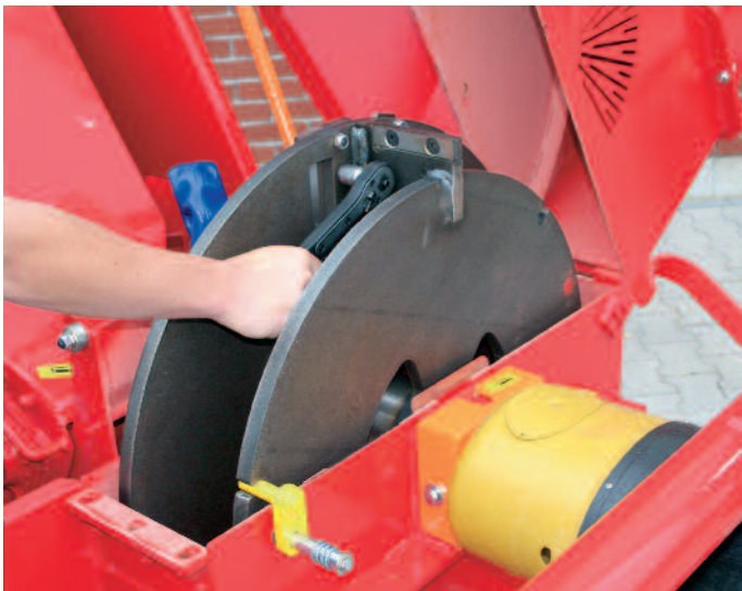
Arretierung der Tandemhackscheibe beim H 130, H 160, H 200 und H 250
