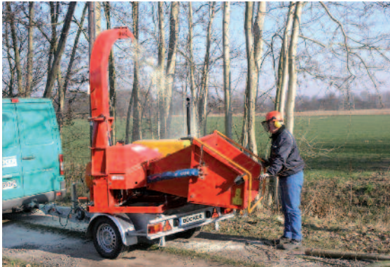
Holzhammer HM 200 auf Einachsfahrgestell mit Drehkranz, Schwenkbereich 360°
