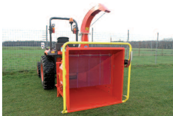
Großer Einführtrichter mit umlaufendem Sicherheitsbügel
