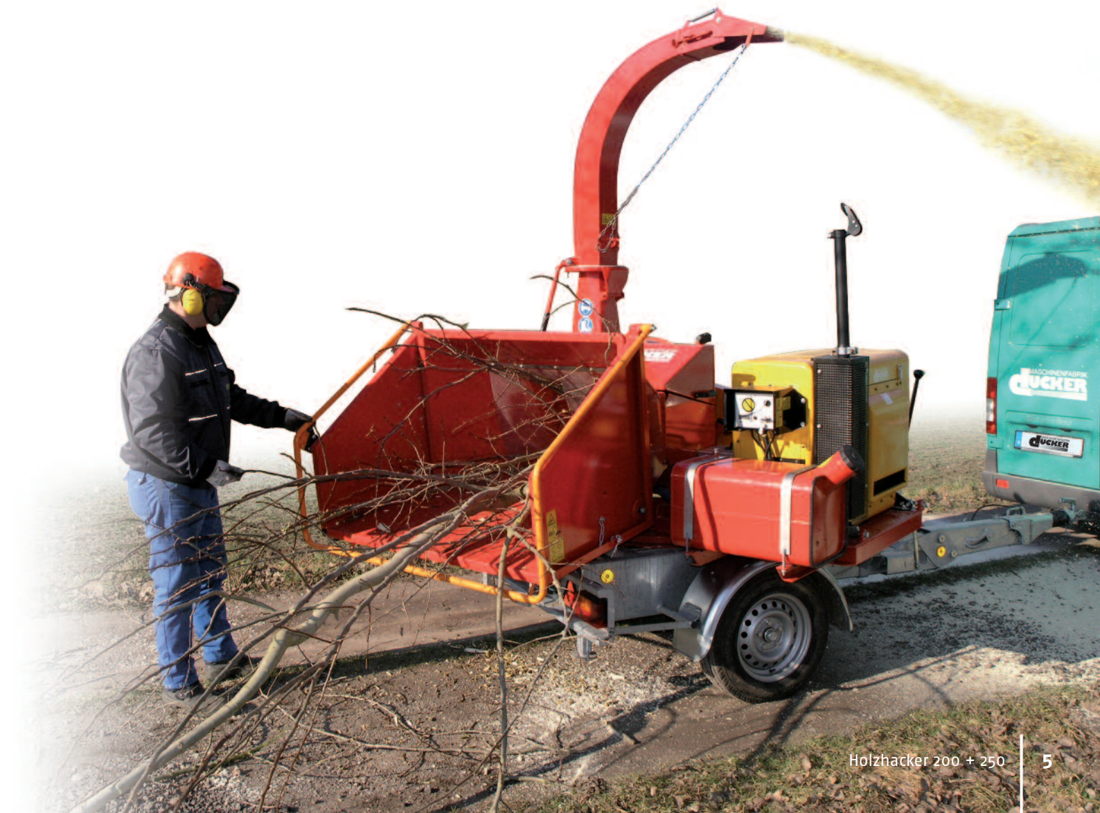
Holzhammer HM 200 auf Einachsfahrgestell mit Drehkranz, Schwenkbereich 360°
