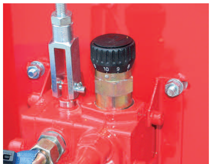
Die Drehzahlregelung der Einzugswalzen am Holzhaacker der Baureihe 230
