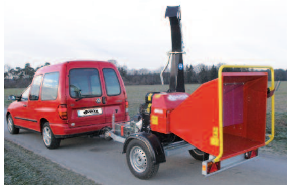
Dem HM 130 genügt ein PKW mit Kugelkopf-Zugvorrichtung für den Transport zum Einsatzort.
