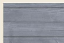
Nach einer technischen Trocknung werden die Oberflächen der Hölzer farbig lasiert. Die Lasur schützt das Holz gegen Bläue, Vergrauen und Witterungseinflüsse. Für dauerhaften Schutz und zur Erhaltung der wertigen Optik sollte die Lasur regelmäßig erneuert werden. (Art. 1399: braun bzw. Art. 1397: grau). Farbig lasierte Nadelholzprodukte sind im Preisvergleich günstig und brauchen keinen Erstanstrich. Sie sind leicht zu bearbeiten und zu montieren.
